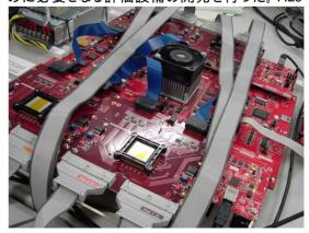
年度は、従来型演算器アレイ型アクセラレータの弱点であるデータ伝搬オーバヘッドを削減し、さらに、ベクトル演算機構としても利用可能な新しい多数演算器制御方式を考案し、アプリケーションの整備から、ハードウェア実行モデル(FPGA実機上で動作中)の開発までを実施した。また、LSI化のために必要となる評価設備の開発を行った。
