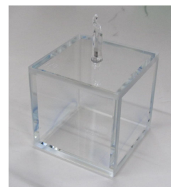
図 2 実験に用いた一辺 5cm の立方体の K-Rb ハイブリッドセル
