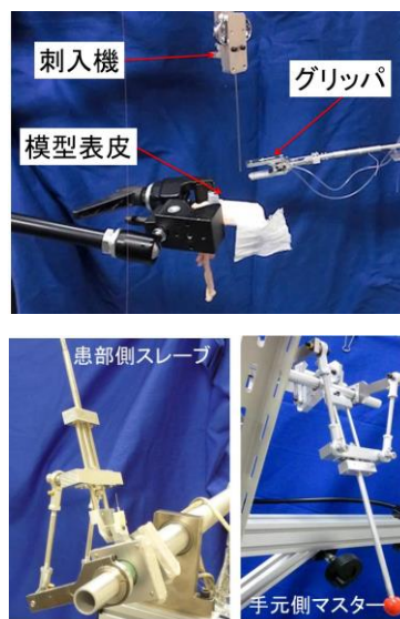
図 9 遠隔線源刺入装置（上）とグリッパの遠隔位置決め部（下）
