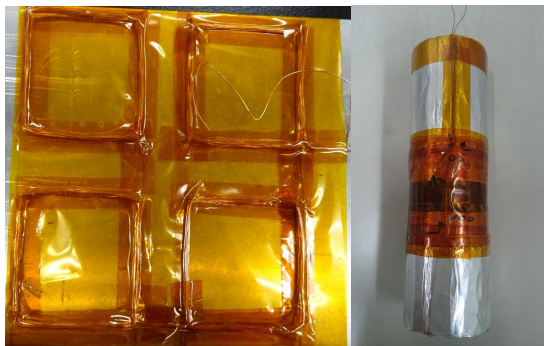
図8 左: x, yシムコイル(円筒巻き付け前) 右: zシムコイル(円筒巻き付け後)
