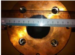
図5. 銅は熱輻射の効率が悪いので銅表面そのままでは表面の熱測定が困難である。それで黒体スプレーで吹きつけ輻射効率の良い表面にした。これでターゲットの表面にビームの温度、形状が容易に分かる。
