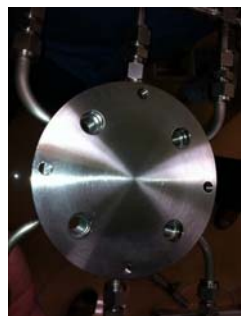
図8. CrN(1 \mu m)でコートした場合。この場合も表面の強度は格段に増す。
