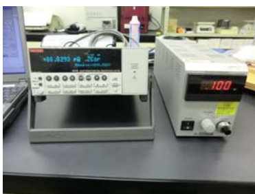
図9. チェンバー方式によるリアルタイム測定のためのエレクトロメータ(左)。右はチェンバーに付加する高圧電源。通常200V。
