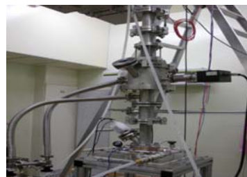
図2. ターゲットシステムをくみ上げた写真。一番下にターゲットの銅の部分が見える。上方を真空にし陽子ビームを照射する。
