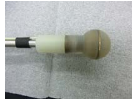
図11. 熱外中性子用の材料(LBO)を加工し、表面を導電性にして装着。
