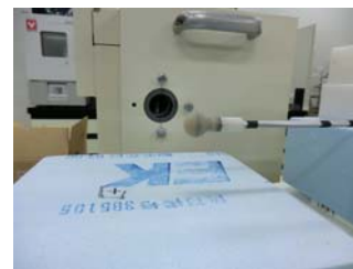
図12. 熱外中性子測定用チェンバーを設置し測定を行っている状況。
