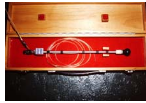
図10. IC-17型のチェンバー(Far West Technology社)。このチェンバーは組織等価プラスチック(右の黒の球形部)。この部分をBNCT用の熱外中性子測定用の材料に交換した。
