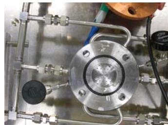
図1. 噴流式ターゲットを上から見た図。中心に小さい穴がたくさん開いておりここから水流を丈夫に吹き上げる。上の銅がターゲットでこれを上にかぶせこの銅を冷却する。実験では十分な冷却能力があることが分かった。
