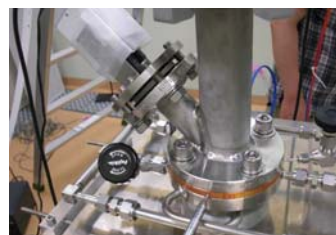
図3. ターゲット部分の拡大図。8mmの厚さの同ターゲットの中心部に横から穴を開け熱電対を差し込んでいる。反対側にも熱電対があり、2本差し込んでいる。左に見えるのは輻射温度計で照射中のターゲットの温度を測定する。ここにサーモカメラも設置して温度を測定する。中心に小さい穴がたくさん開いておりここから水流を丈夫に吹き上げる。実験では十分な冷却能力があることが分かった。
