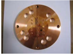
図4. ピン方式の冷却ターゲット。ピンの写真の例。その反対側にLiなどの金属を貼り付ける。冷却能力は噴流式と殆ど差はなかった。
