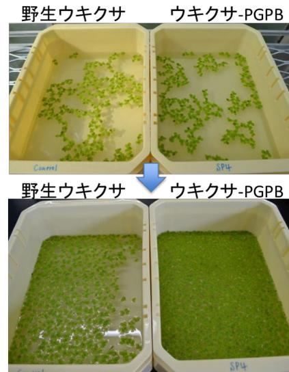
図 5. ウキクサと PGPB の共生系リアクターによる下水二次処理水からの窒素除去
