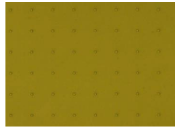
図 7 ダイヤモンド基板の上にアレイ状に作製された直径 1 \mu\text{m} のタングステンパターンのレーザー顕微鏡写真。
