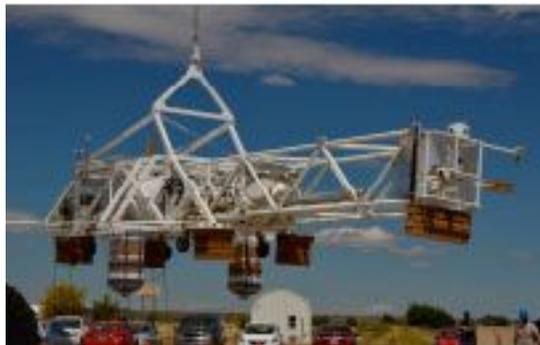
右端が鏡筒先端であり左端に検出器を組み込んだ与圧容器、姿勢系、通信系がある。
