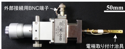
図 6. 開発した球面収差補正器の外観
