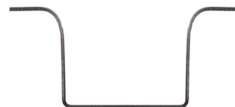
(b) 最適化工法によるスプリングバック
