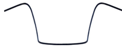
(a) 通常のハット曲げによるスプリングバック
