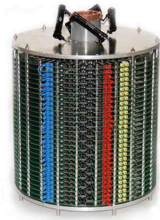
図4 30モジュールを採用する LTD 型パルスパワー発生器
