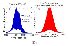
Fig.1(a)と1(b)を比較すると,実験で得た干渉スペクトルのボトムの形状はシングルモードスペクトルの計算結果と明らかに異なる.これはSOAデバイス動作に複数のモードが寄与してマルチモードで動作していることが原因であると考えら
