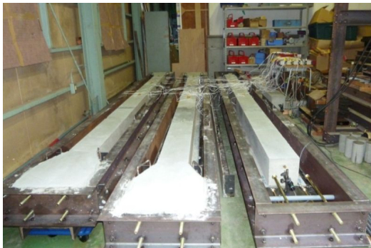
写真1 大型供試体を用いた乾燥収縮試験
