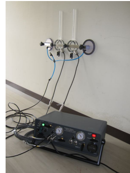
写真2 表面吸水試験装置
