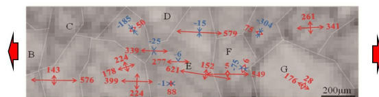
図8 Fe-Mn-C 合金の引張り変形したままの状態での主応力分布。
