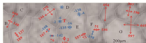
図7 Fe-Mn-C 合金の引張り変形前 (焼鈍状態) の主応力分布。赤矢印は引っ張り、青矢印は圧縮を示し、数字の単位は MPa。
