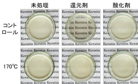
図 2 還元-酸化応答性と加熱前処理の影響
