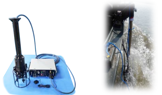
ハイドロフォンアレイ外観（左）およびハイドロフォン部拡大図（右）
