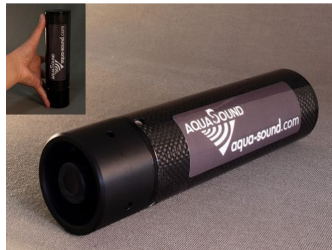
図 1 開発した深海用音響タグ。カーボン製の録音機本体(AUSOMS-mini)に加速度および深度記録ができるデータロガー(ORI400-D3FT)および回収用の VHF 電波発信機と浮力体を組み合わせたシステム。
