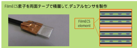
図 3 . デュアルセンサの構造と外観
