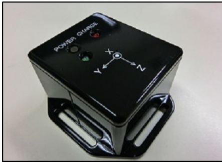
図 1. 三次元加速度計 Pocket IMU2 重量 50g
