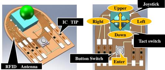
図3 口腔内ジョイスティックリモートコントローラー(5号機)
