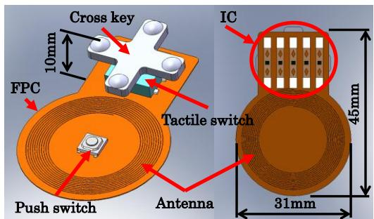
図4 十字スティック式口腔内リモートコントローラー(6号機)
