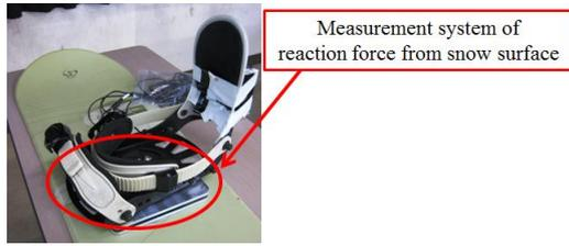
図3 雪面反力計測システム
