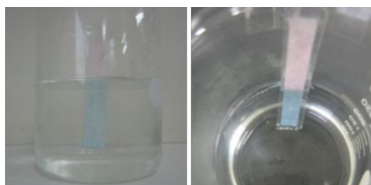
図2 変色剤として1-ペンタデカノールを用いたときの、サーモシートの温水中(50℃)での変色の様子
