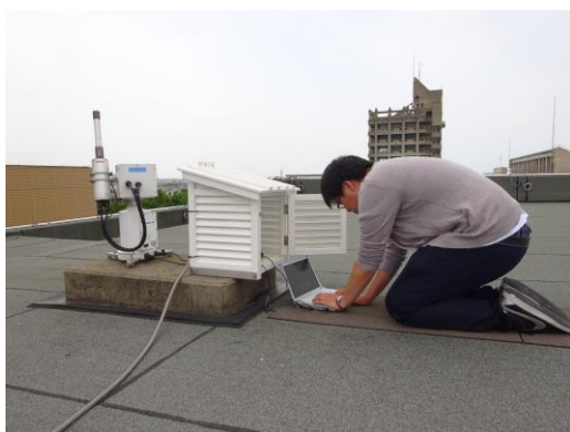
図1 金沢工業大学24号館屋上に設置してあるスカイラジオメーター
