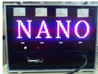
図3 P-CyD-ZrO 2 ナノ粒子を分散したFSC-LCD 試作機
