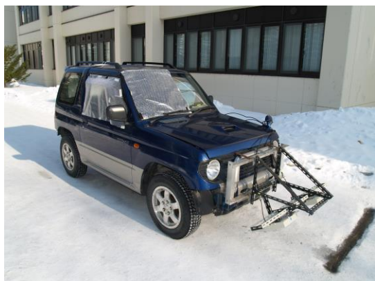
図1：RF-ID アンテナを実装した実験車両
