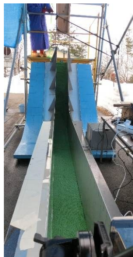
図 6 模型斜面外観
