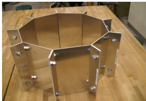
写真・大型 9 角形アルミニウム型枠
