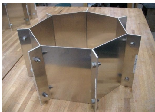
写真・大型 7 角形アルミニウム型枠
