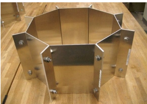
写真・大型 8 角形アルミニウム型枠
