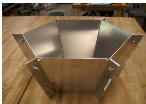
写真・大型変形 6 角形アルミニウム型枠
