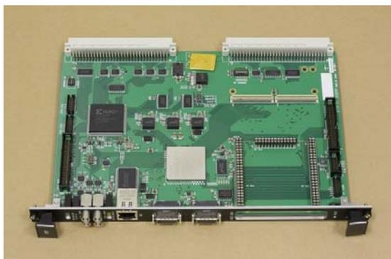
図 3. 汎用 FPGA モジュール PT7。6U 標準サイズの VME モジュールである。
