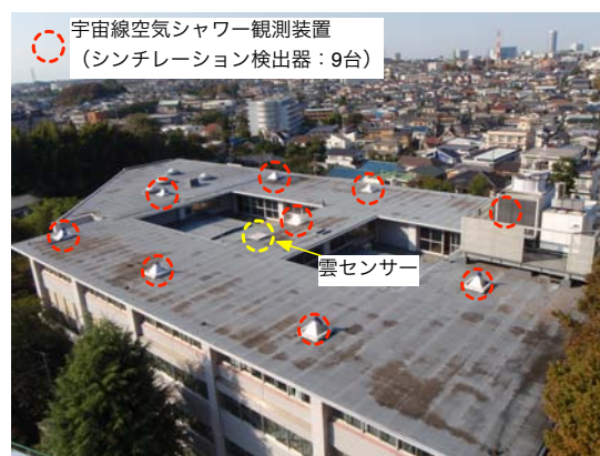
図 2 神奈川大宇宙線空気シャワー観測装置
