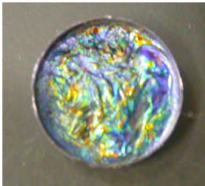
Fig. 1 溶媒蒸発法により成膜したフィルム
