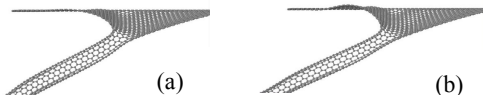
図 7 (6,6)ナノチューブで接合されたピラードグラフェンのせん断変形スナップショット (a)変位 50、(b)変位 60
