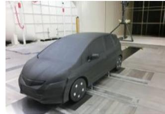
図 12 Honda Fit 25%モデル風洞 試験 (<http://www.honda.co.jp/Fit/> )
