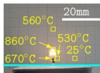
図5. 熱電対による温度測定結果
