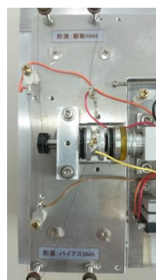
図 8 前進用 SMA アクチュエータ部
