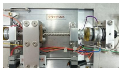
図 10 クラッチ用 SMA アクチュエータ部
