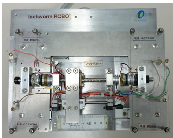
図 7 単軸インチワーム機構
