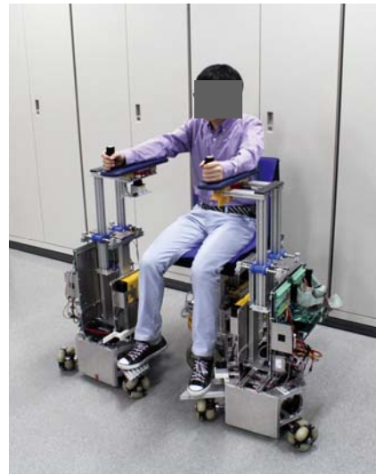
図5 開発された分散協調型歩行支援ロボット車椅子支援モード
