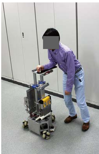
図3 開発された分散協調型歩行支援ロボット片側支援モード
