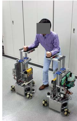
図4 開発された分散協調型歩行支援ロボット両側支援モード
