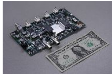
図9 4K リアルタイム処理装置
