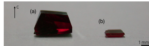
図 1. 混合溶媒を用いてバルク成長した DAST 結晶: (a) 混合溶媒、(b) メタノール溶媒
