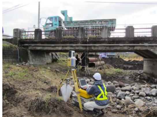
図-2 老朽化した橋梁（法量橋）の詳細調査
