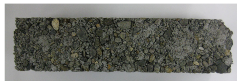
図 7 暴露試験後の PoC はり
