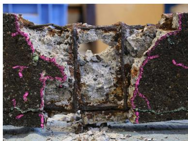
図4 等曲げスパンの破壊状況
