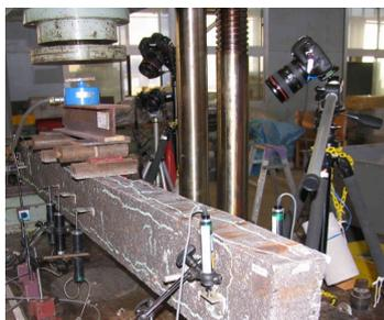
図12 三次元計測用 画像撮影状況
