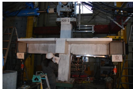
写真1 スラブおよび直交梁を付加した十字形 PRC 柱梁部分骨組の実験 (第一シリーズ)
