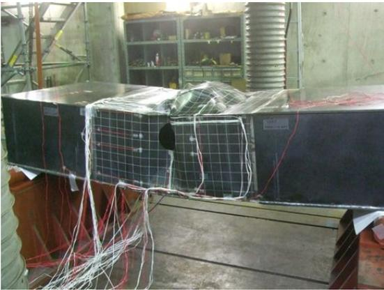
図 3 4点曲げによる箱型鋼製模型の最終強度後の座屈・崩壊状況
