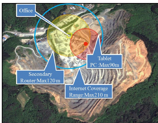
図3 採掘場内の無線 LAN 環境の構築
