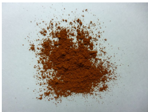
図1 松尾鉱山坑廃水から合成したゲーサイト
