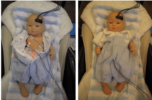
図1 乳児へのセンサーの設置状況 前額部：近赤外分光分析法による脳活動測定のためのセンサー 胸部：心電図測定のためのセンサー
