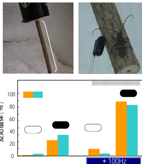
(図2) 上左 加振器に接続した棒材（長さ30cm、直径2.5cm）上右 ダミーの供試虫への提示
