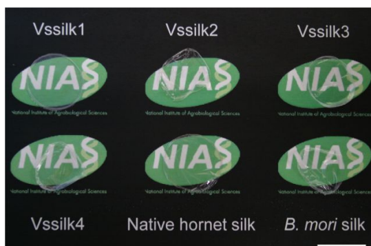
図2 人工合成したホーネットシルクのフィルム。天然ホーネットシルク(Native hornet silk)、および家蚕絹フィブロイン(B. mori silk)のフィルムも比較で示した。
