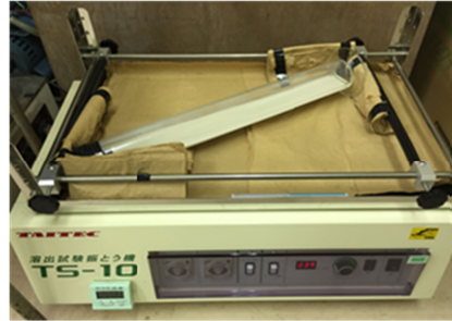
写真1 横転振動攪拌装置
