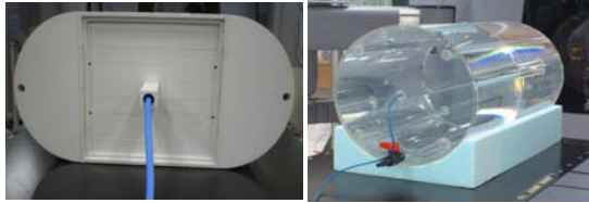
図1 CBCTの吸収線量計測用ファントム (a) 固体ファントム, (b) 円筒形水ファントム
