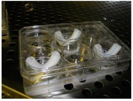
8mm ストレートの人工血管を 6cm 長に切断し 6-well culture plate に U 字にして挿入、人工血管内側に清潔な生食 2ml を、外側に緑膿菌生食懸濁液を 5ml 注入した。60 時間までの 9 つのタイムポイント (0、6、12、18、24、30、36、48、60 時間後)で人工血管内側の生食を採取し寒天培地に塗布、培養することで
